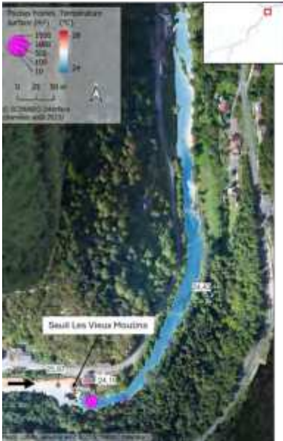
Figure 82 : Mosaïque thermique illustrant le refroidissements tout relatif observé en aval du seuil des Vieux Moulins (zone F_De11).
