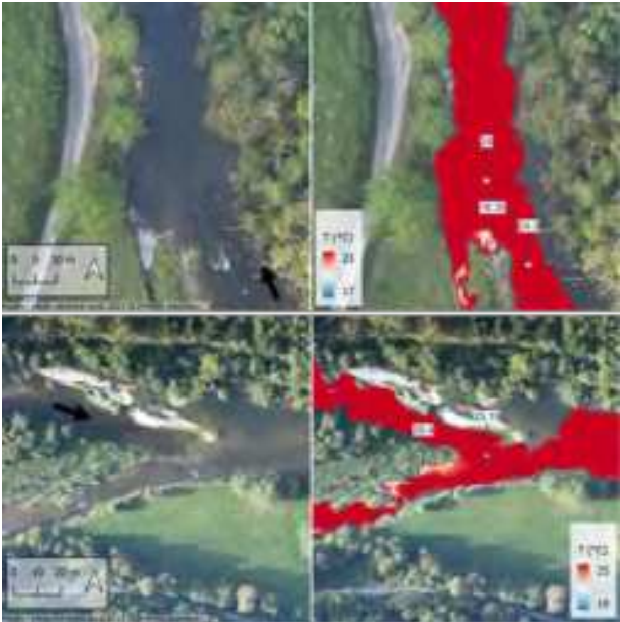
Figure 117 : Mosaïque thermique et orthophoto illustrant des exfiltrations de banc très localisées (haut : point kilométrique 21.8, bas : point kilométrique 26.9).
