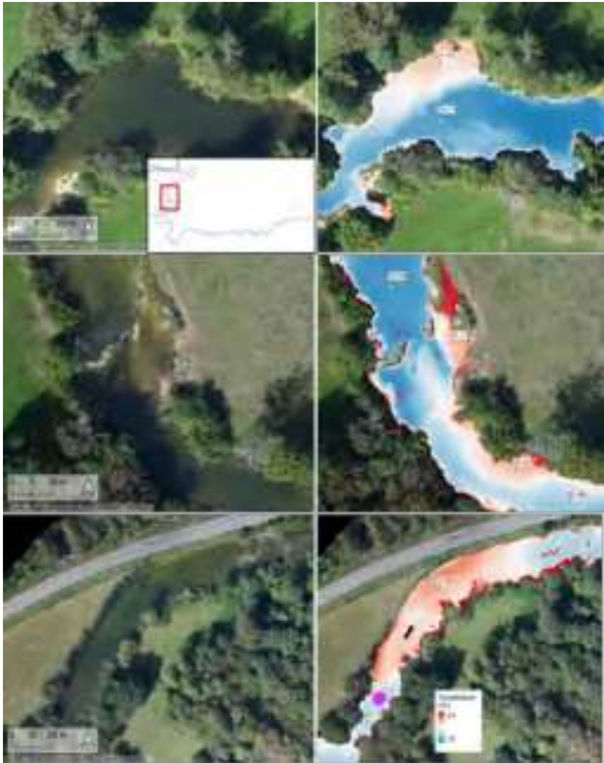
Figure 19 : Mosaïque thermique et orthophoto illustrant des exemples de réchauffements observés en bordure le long du linéaire de la zone C_Cu6.
