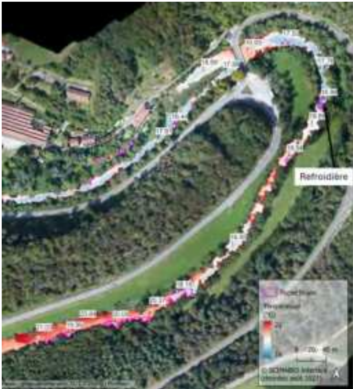
Figure 31 : Mosaïque thermique illustrant le refroidissement généré par les nombreux apports hyporhéiques et la confluence de la Refroidière (zone F_Cu4).
