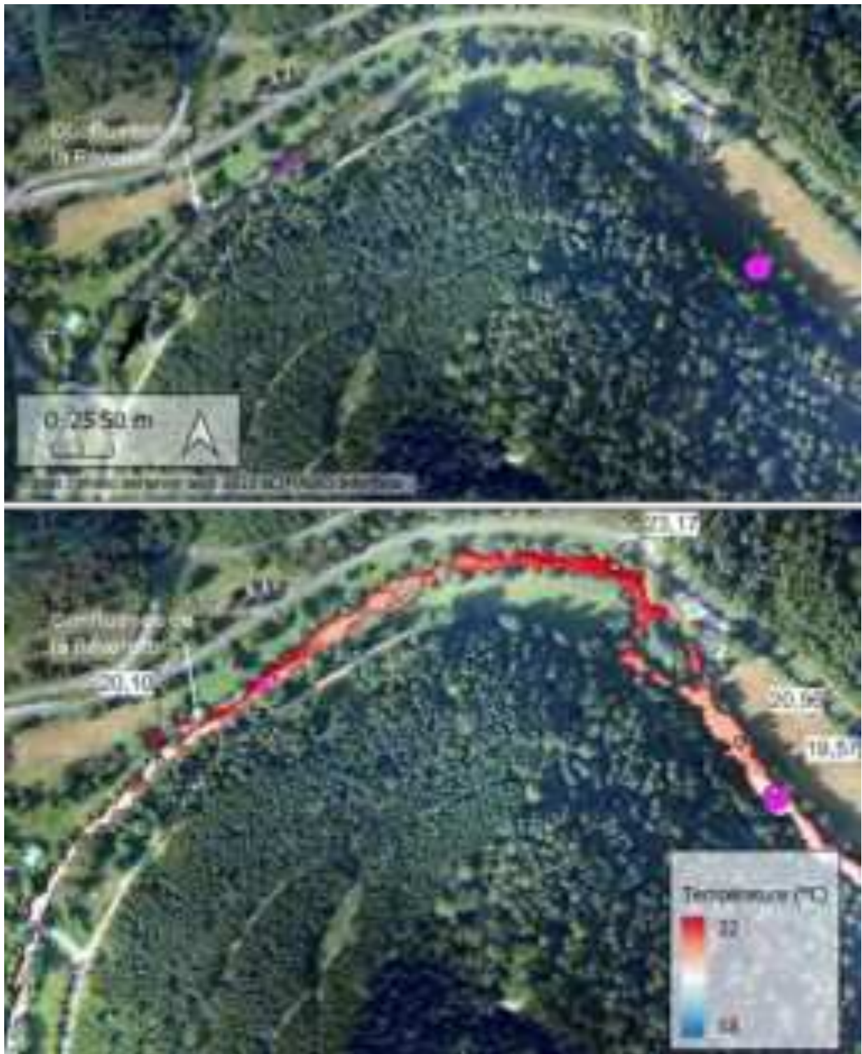
Figure 53 : Mosaïque thermique et orthophoto illustrant le réchauffement observé à la confluence de la Réverotte (zoom 2 de la figure 51).
