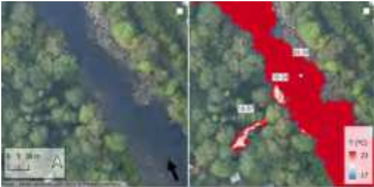
Figure 118 : Mosaïque thermique et orthophoto illustrant l'arrivée d'eau plus fraîche observée au niveau de la source de la Forge (point kilométrique 22.5).
