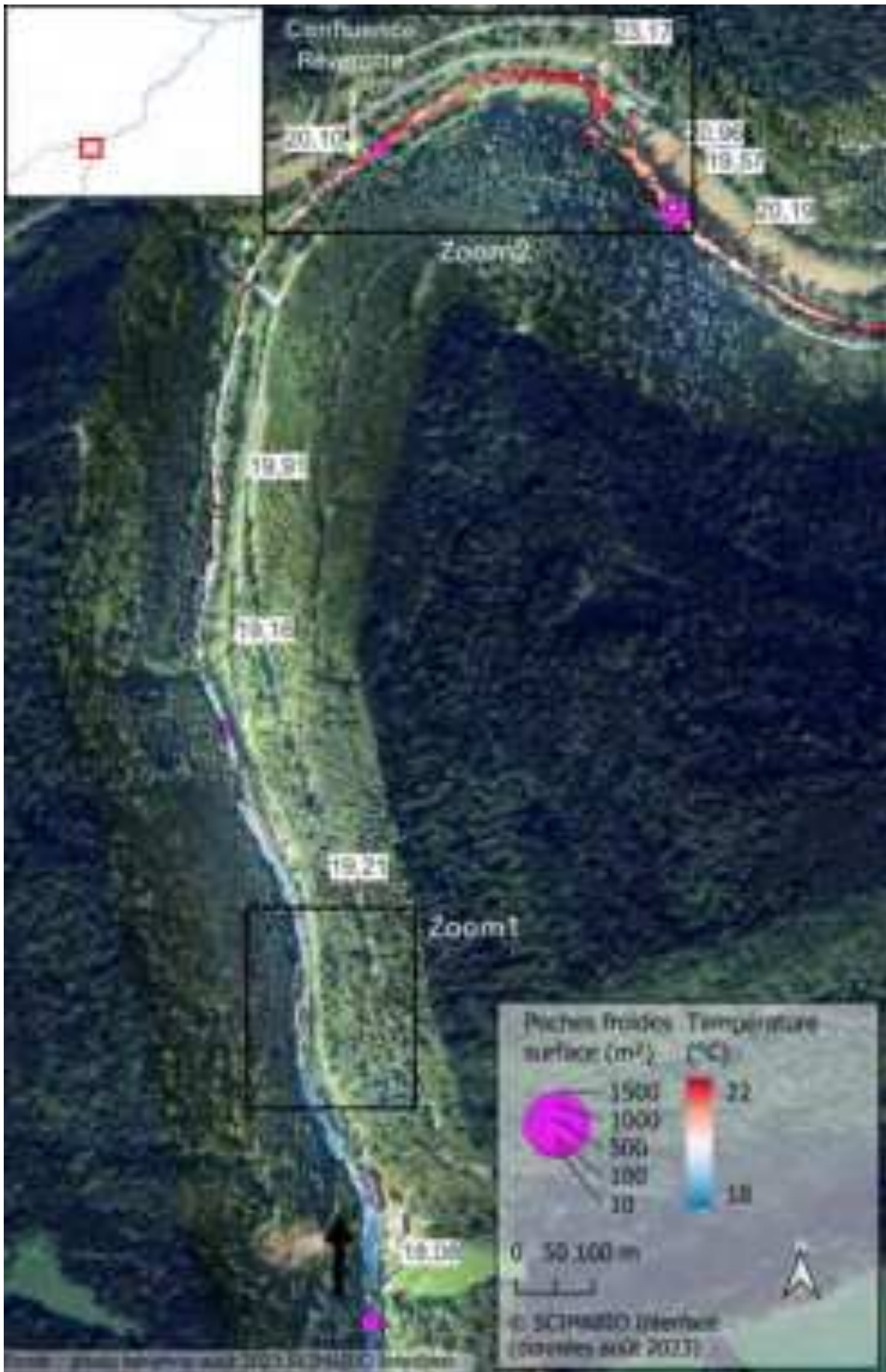
Figure 51 : Mosaïque thermique de la zone de réchauffement C_De4 montrant l'absence de poches froides sur ce linéaire, des réchauffements latéraux et la confluence de la Réverotte.
