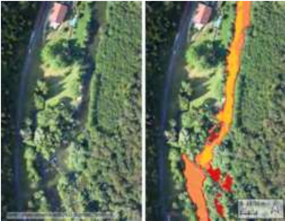
Figure 94 : Mosaïque thermique et orthophoto montrant l'aval du seuil du moulin du dessus qui représente une zone avec une amélioration locale des conditions thermiques vis-à-vis des salmonidés (légende des couleurs voir figure 90).
