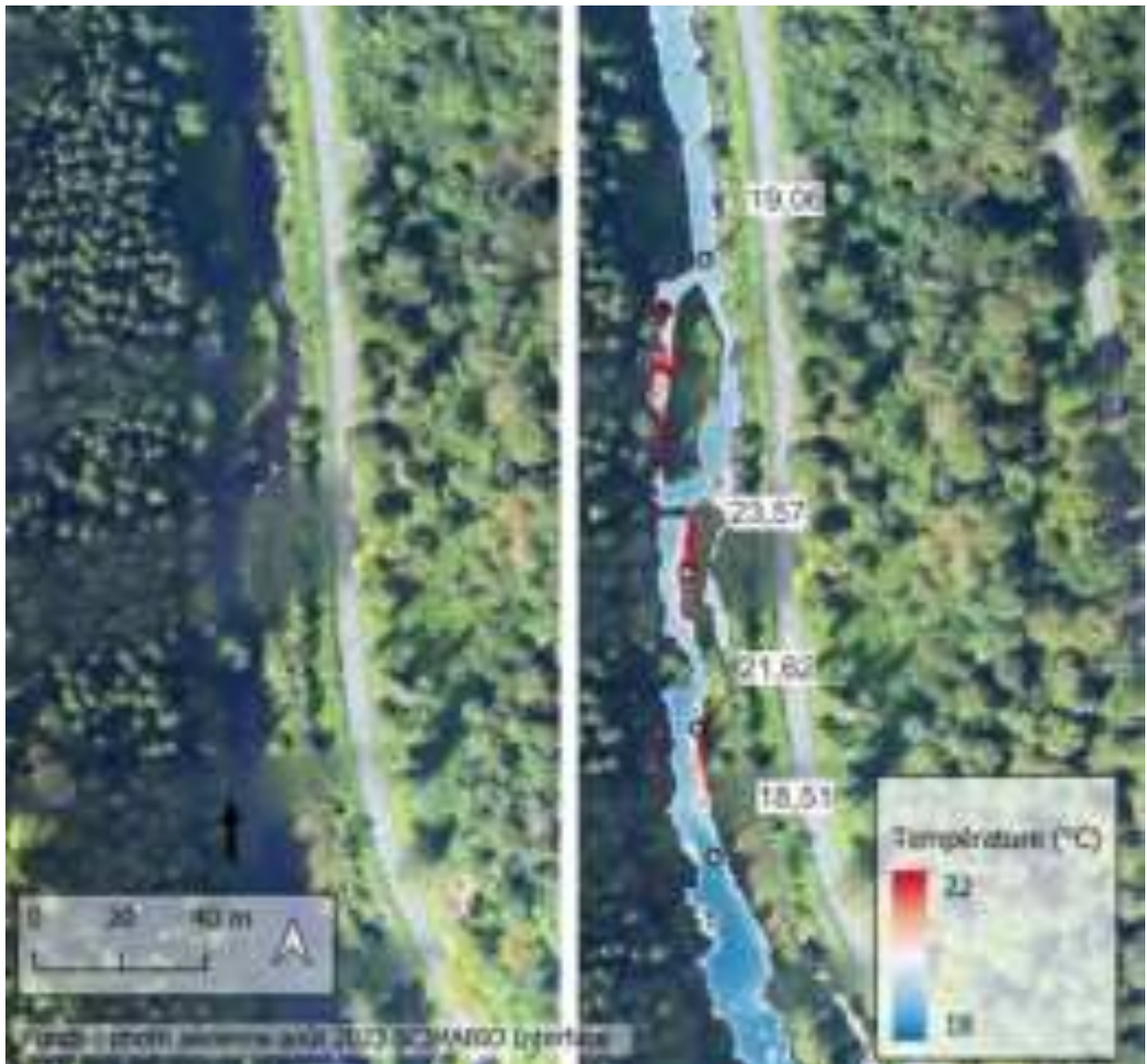
Figure 52 : Mosaique thermique et orthophoto illustrant des réchauffements latéraux (zoom 1 de la figure 51).
