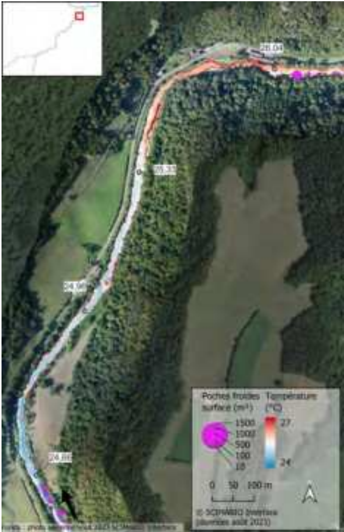
Figure 59 : Mosaïque thermique illustrant un linéaire avec une absence de poches froides entraînant un réchauffement progressif (zone C_De10).
