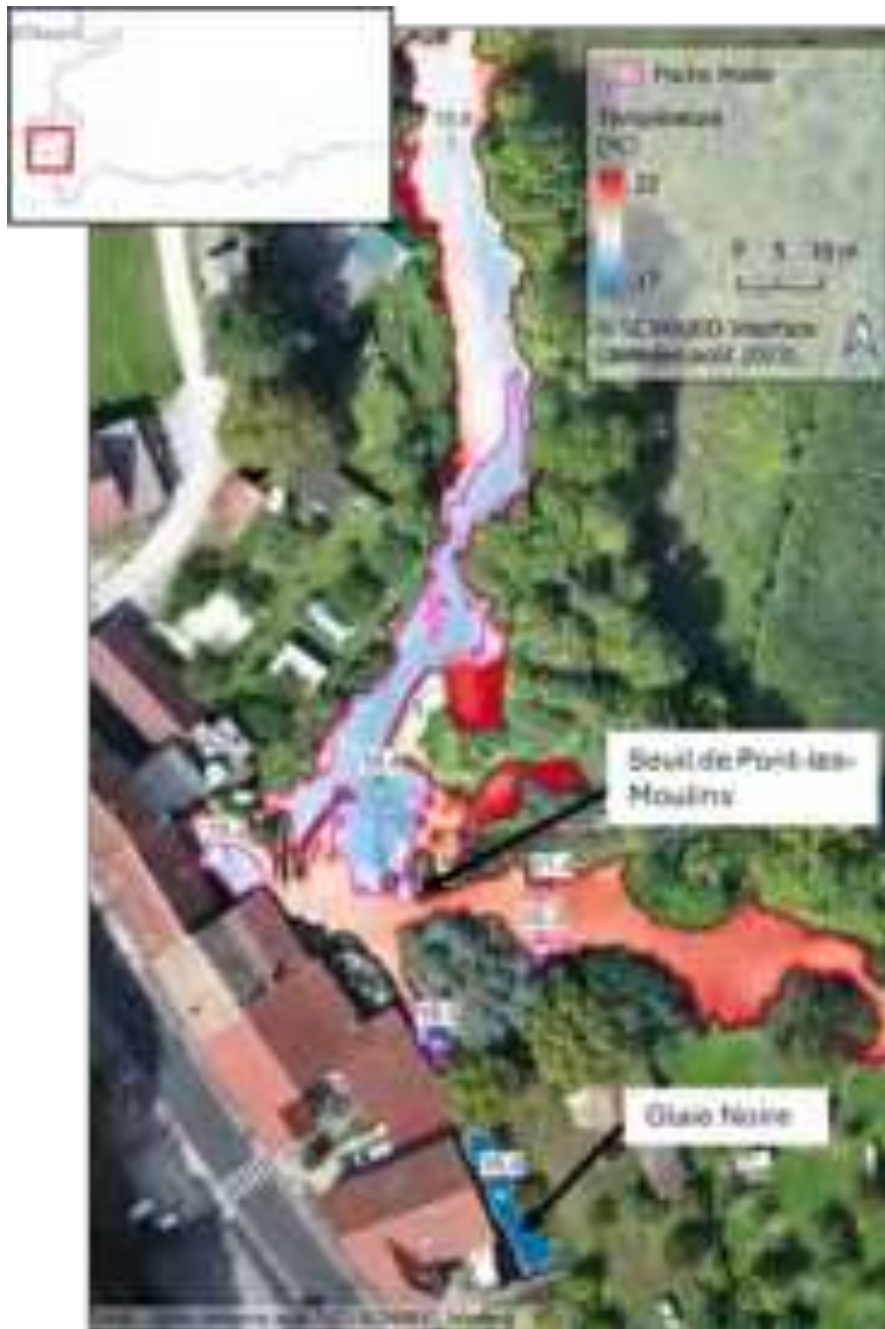
Figure 30 : Mosaïque thermique et orthophoto illustrant les apports hyporhéiques à l'aval immédiat du seuil de Pont-les-Moulins et la confluence de la résurgence de la Glaie Noire (zone F_Cu3).
