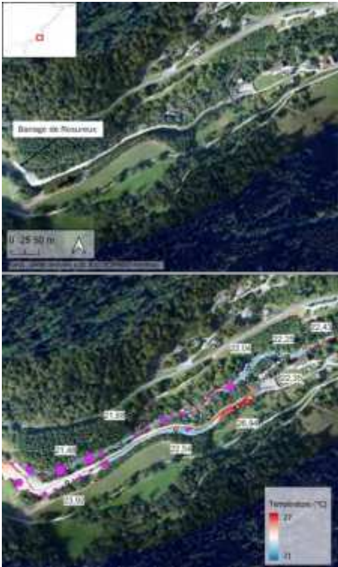
Figure 77 : Mosaïque thermique et orthophoto montrant le complexe barrage et canal de Rosureux avec ses réchauffements 'amont barrage et aval tronçon court-circuité et ses refroidissements (zone F_De6).
