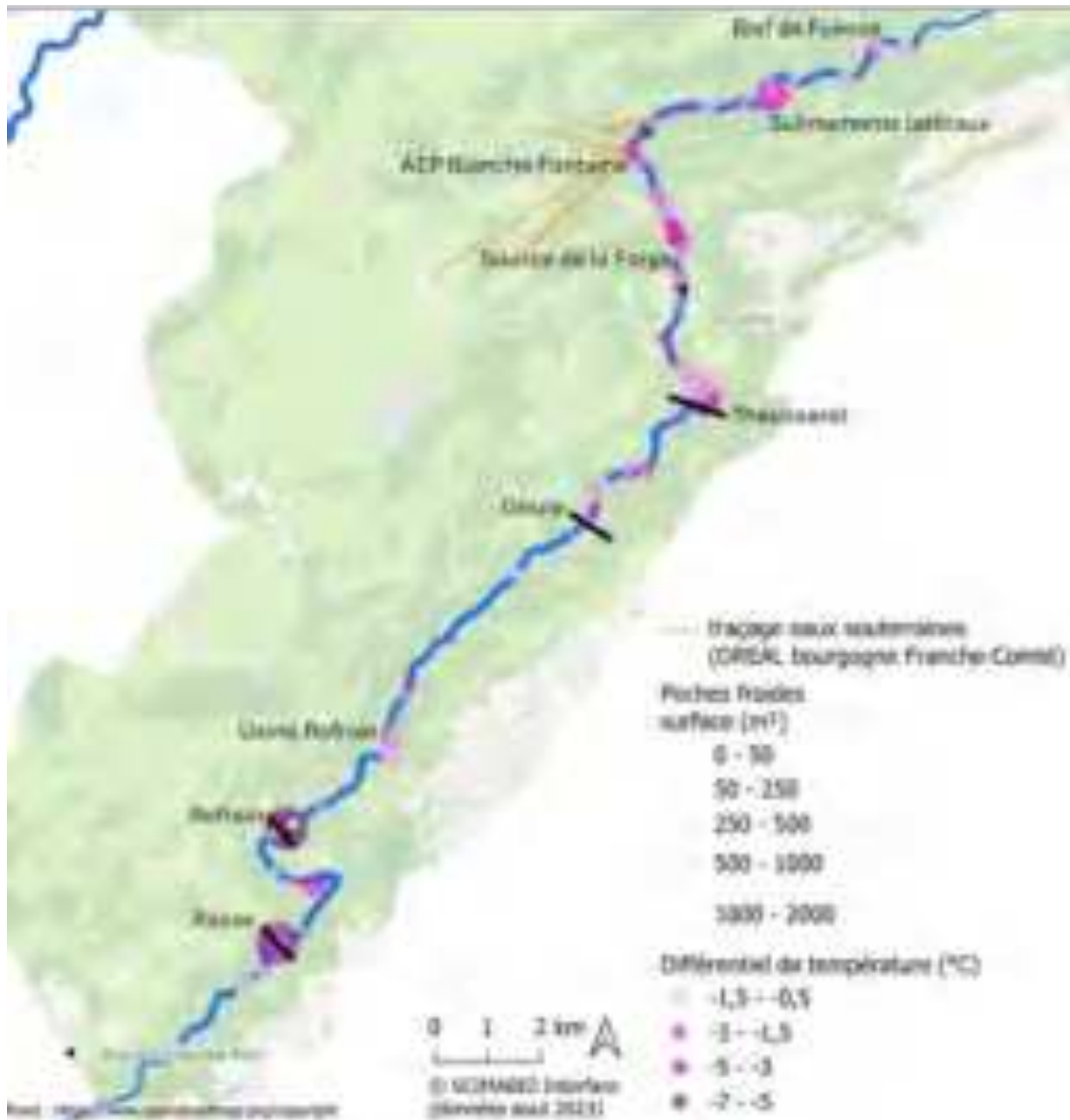
Figure 105 : Répartition des « poches froides » identifiées sur le linéaire du Doubs amont en fonction de leur taille (surface en m 2 ) et de la différence de température médiane avec la rivière. Localisation des tracés karstiques connus (données DREAL Bourgogne Franche-Comté).
