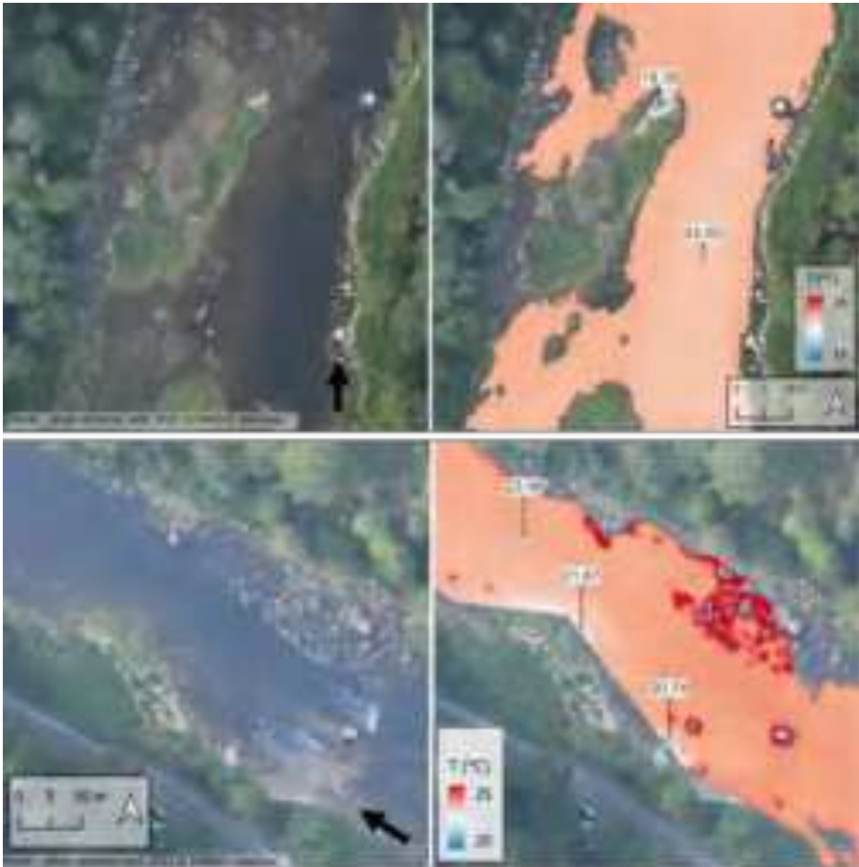
Figure 116 : Mosaïque thermique et orthophoto illustrant des exfiltrations de banc très localisées (haut : point kilométrique 10.8, bas : point kilométrique 19.7).
