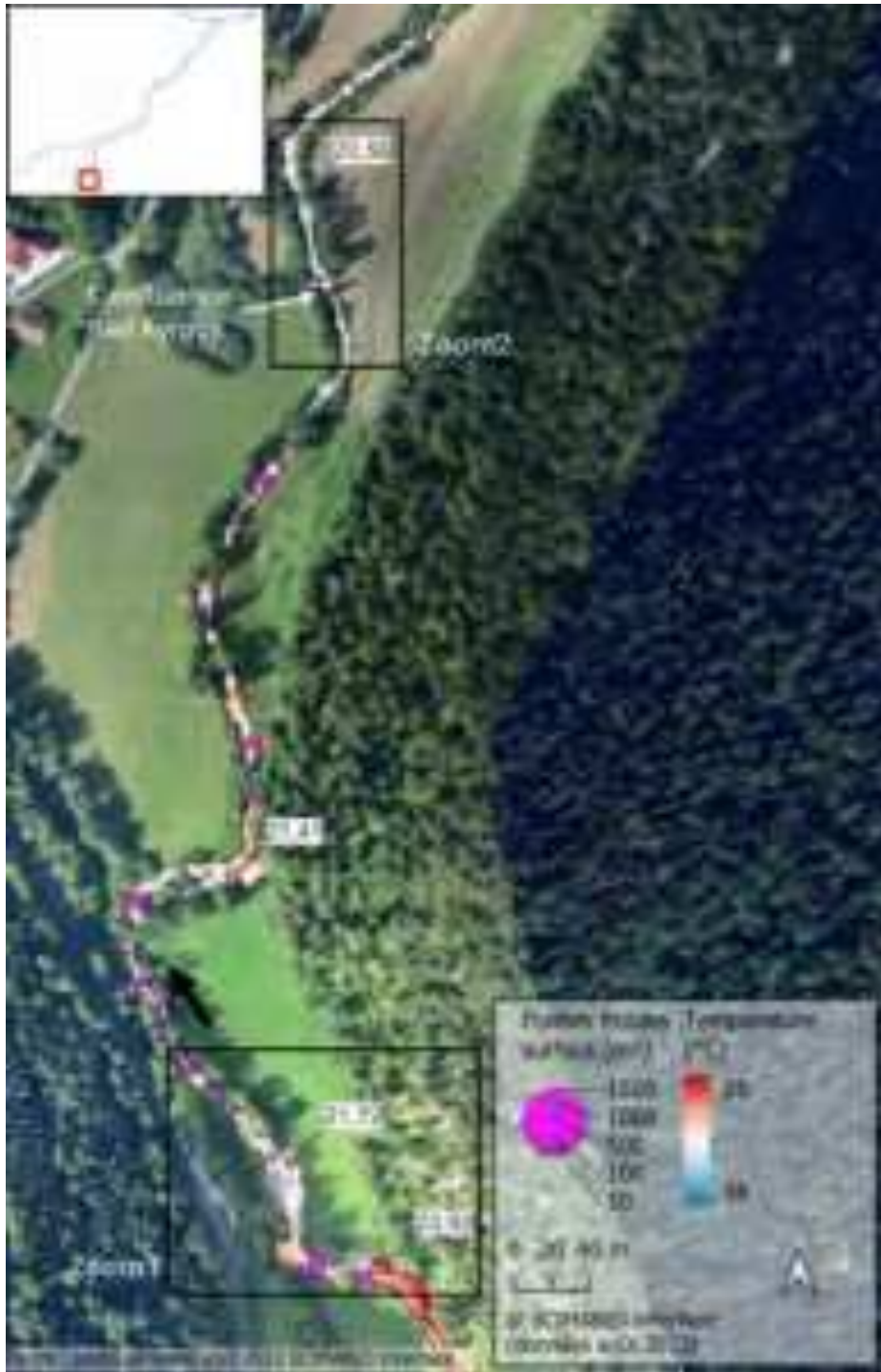
Figure 68 : Mosaïque thermique illustrant les premiers refroidissements observés sur l'amont du Dessoubre grâce à la présence de poches froides et au niveau de la confluence du Bief Ayroux. (zone F_De1).
