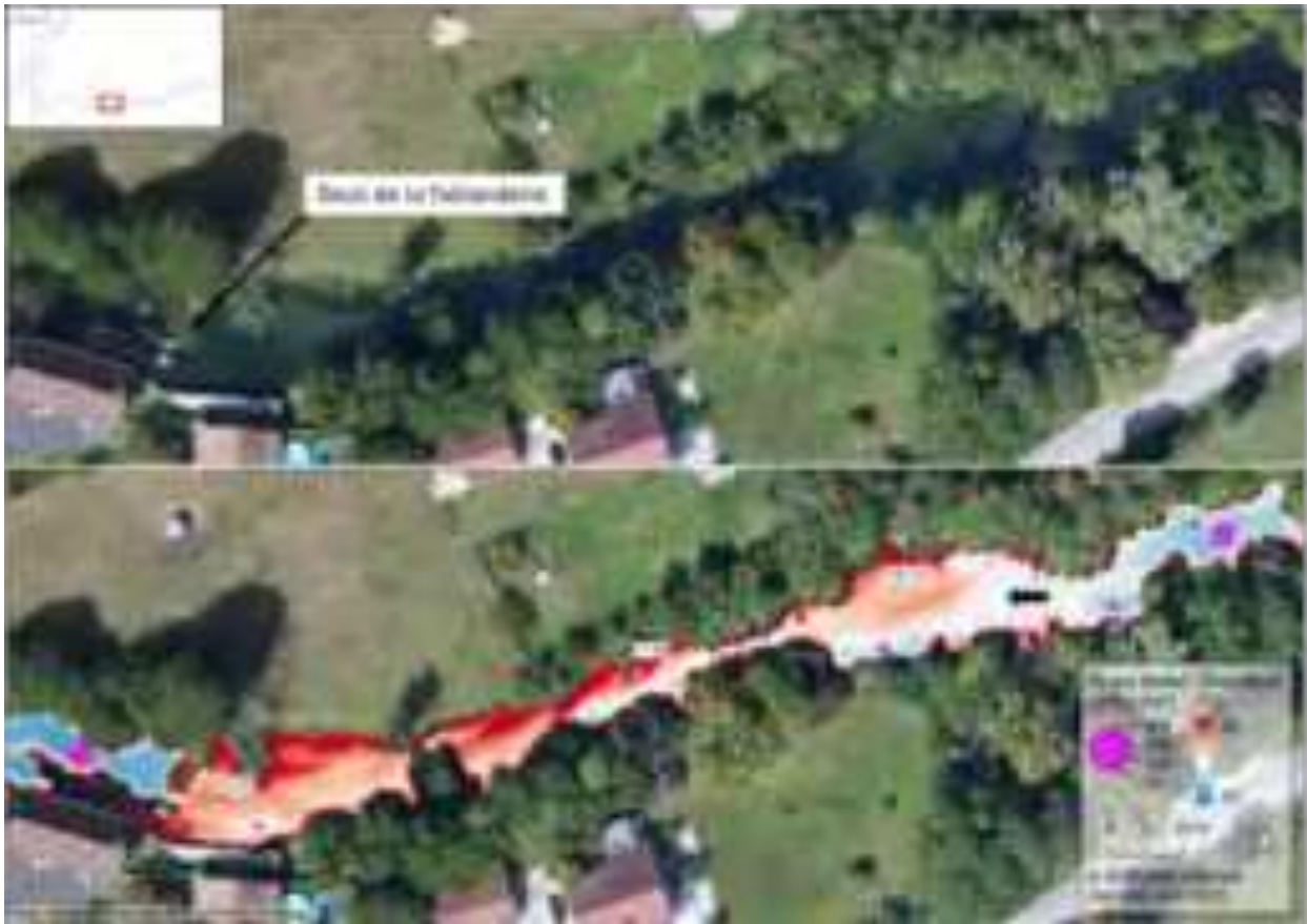
Figure 15 : Mosaïque thermique et orthophoto illustrant le réchauffement observé au niveau du seuil de la Taillanderie permettant de caractériser l'emprise du remous thermique formé par la retenue (zone C_Cu3).
