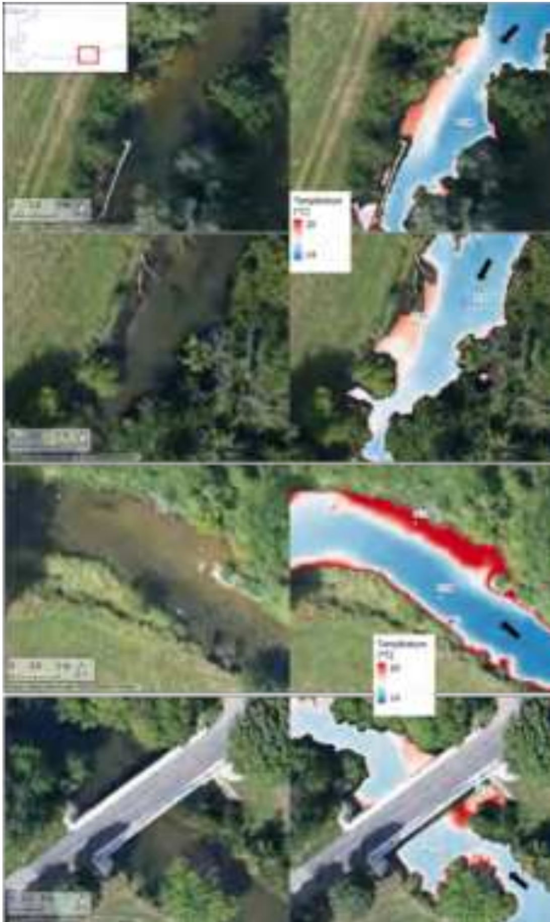
Figure 14 : Mosaïque thermique et orthophoto illustrant des exemples de réchauffements observés en bordure le long du linéaire de la zone C_Cu2.
