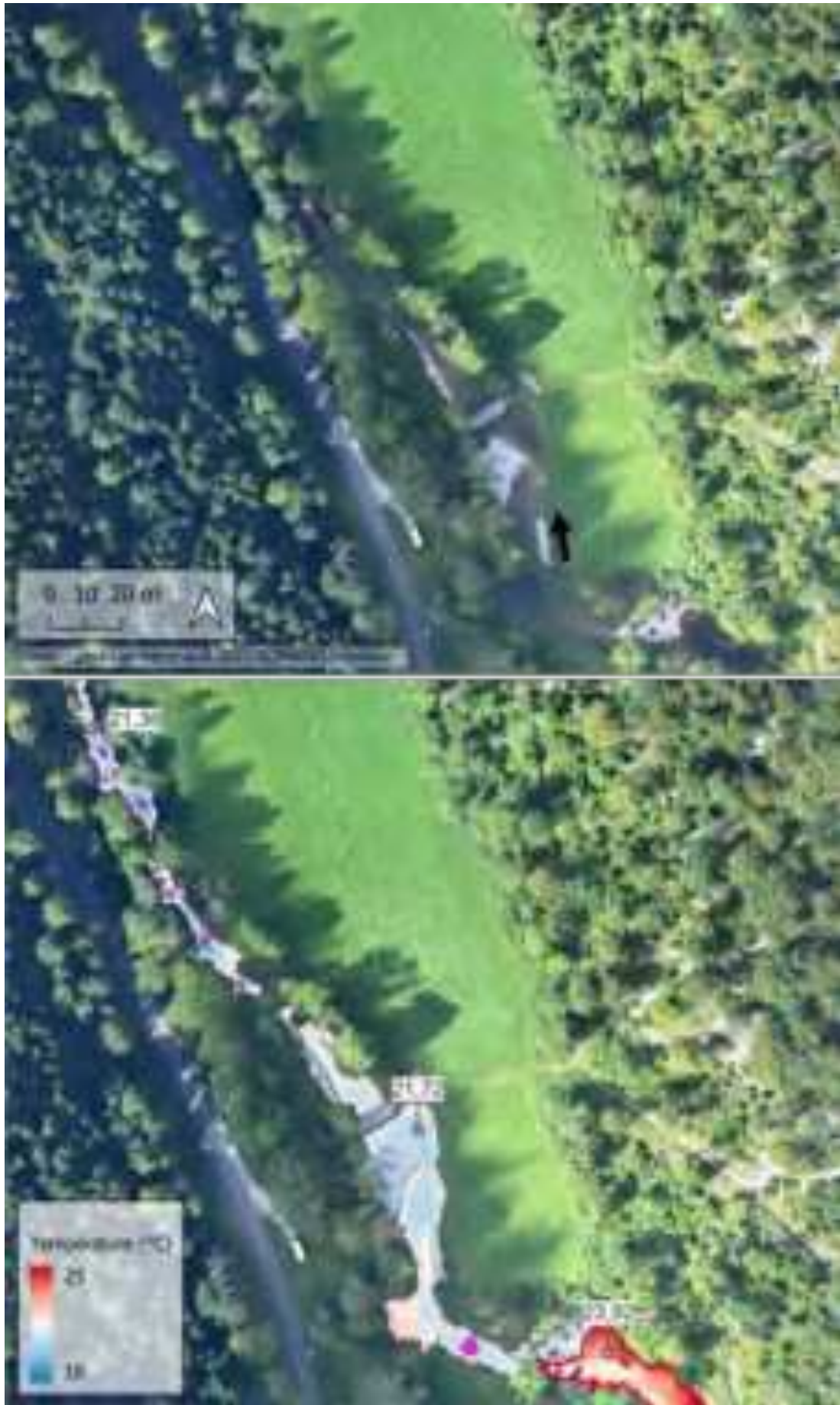
Figure 69 : Mosaïque thermique et orthophoto illustrant le refroidissement provoqué par les poches froides recensées par IRT-a sur l'amont du Dessoubre (zoom 1 de la figure 68).
