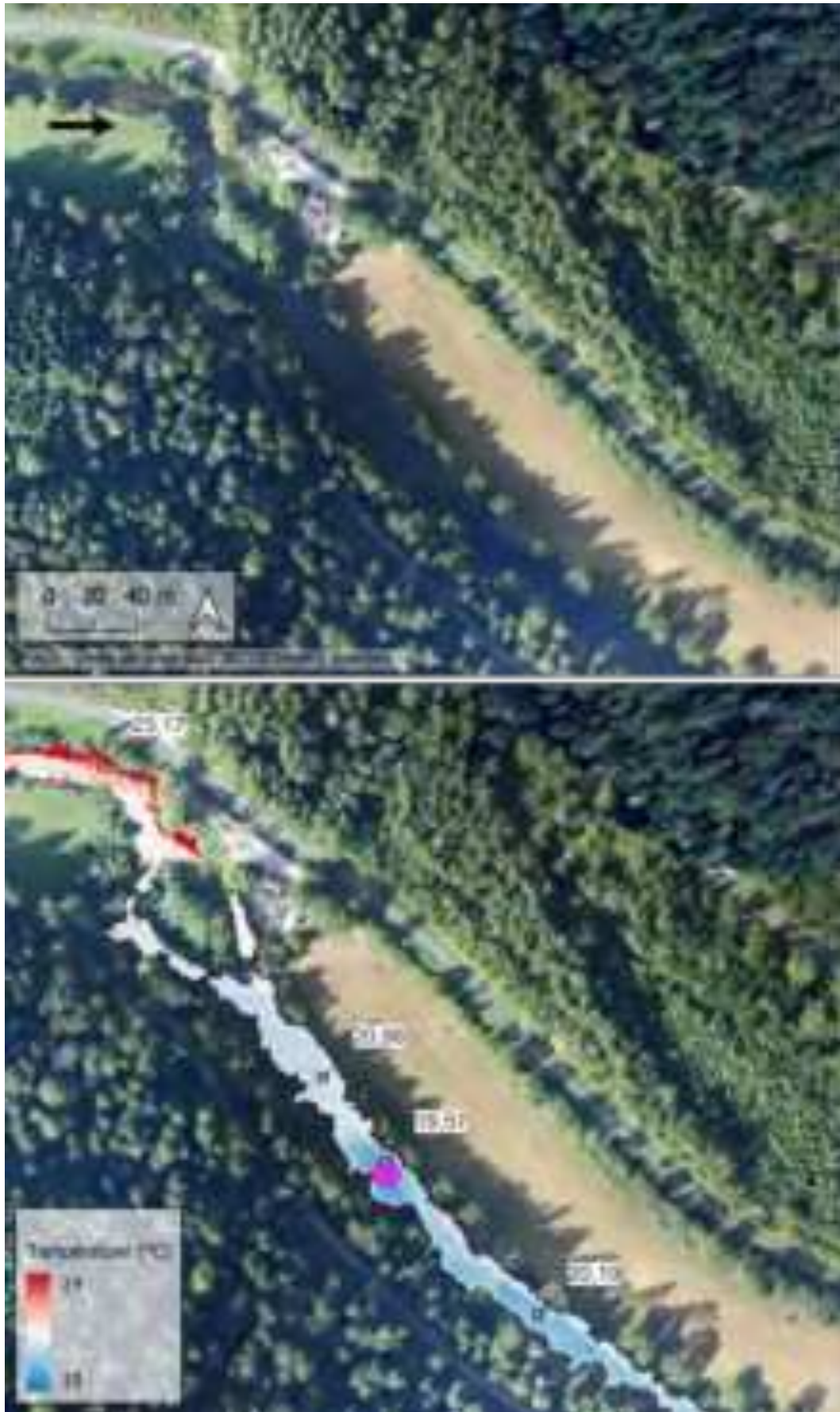
Figure 75 : Mosaïque thermique et orthophoto illustrant un refroidissement généré par des poches froides sur la zone F_De5 (zoom 1 de la figure 74).
