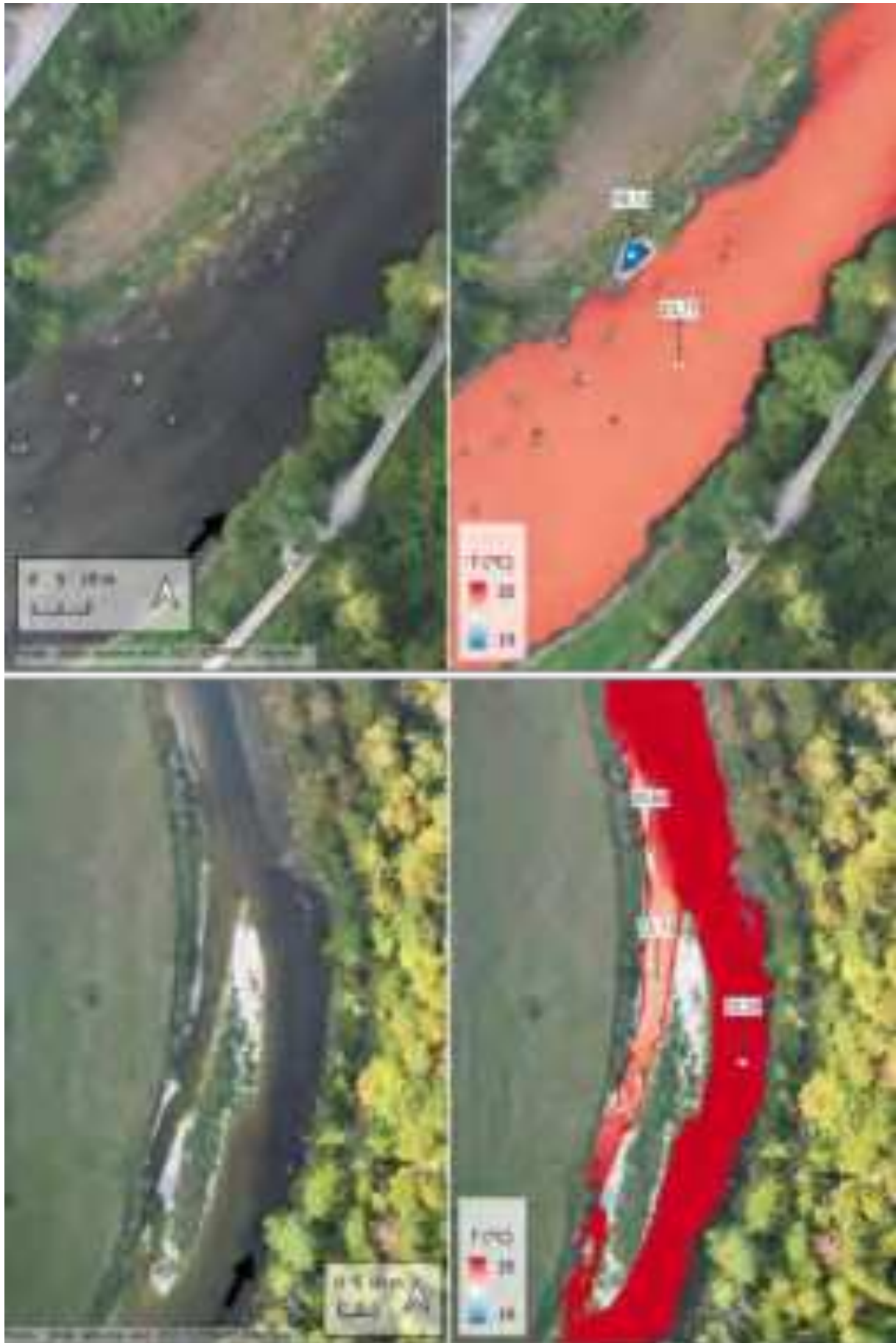
Figure 115 : Mosaïque thermique et orthophoto illustrant des suintements latéraux (haut : point kilométrique 25, bas : point kilométrique 27.7).
