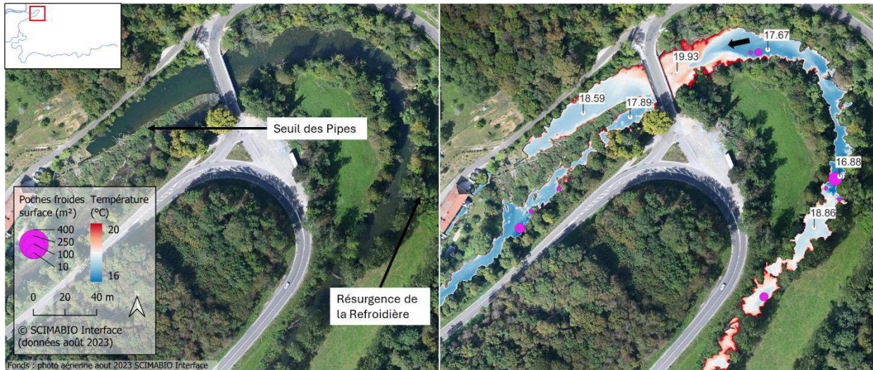
Figure 20 : Mosaïque thermique et orthophoto illustrant le réchauffement observé au niveau du seuil des Pipes qui est contenu grâce à la résurgence de la Refroidière (zone C_Cu7).
