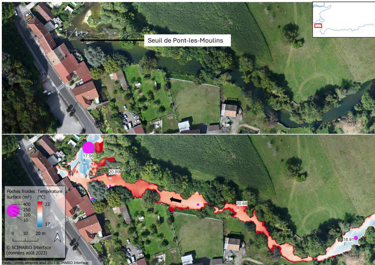
Figure 17 : Mosaïque thermique et orthophoto illustrant le réchauffement observé au niveau du seuil de Pont-les-Moulins permettant de caractériser l’emprise du remous thermique formé par la retenue (zone C_Cu5).
