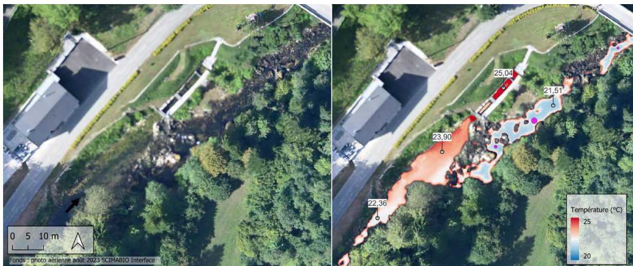
Figure 49 : Mosaïque thermique et orthophoto illustrant le réchauffement au niveau du seuil de l'Engoulot (zoom 2 de la figure 47).
