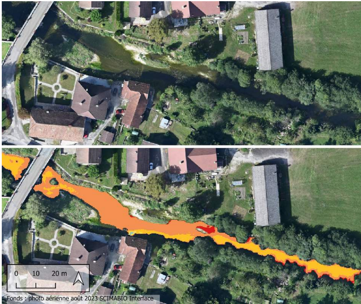
Figure 92 : Mosaïque thermique orthophoto montrant une petite arrivée d'eau froide en rive droite dans le village de Rosureux qui entraîne une plume avec une amélioration locale des conditions thermiques vis-à-vis des salmonidés (légende des couleurs voir figure 90).
