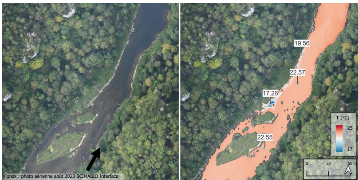
Figure 112 : Mosaïque thermique et orthophoto illustrant un suintement latéral en rive gauche (point kilométrique 10.5).
