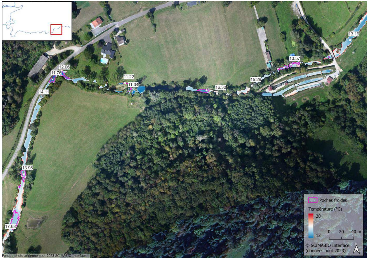
Figure 28 : Mosaïque thermique illustrant le refroidissement observé grâce aux nombreux apports karstiques recensés en aval de la pisciculture de Cusance (zone F_Cu1).
