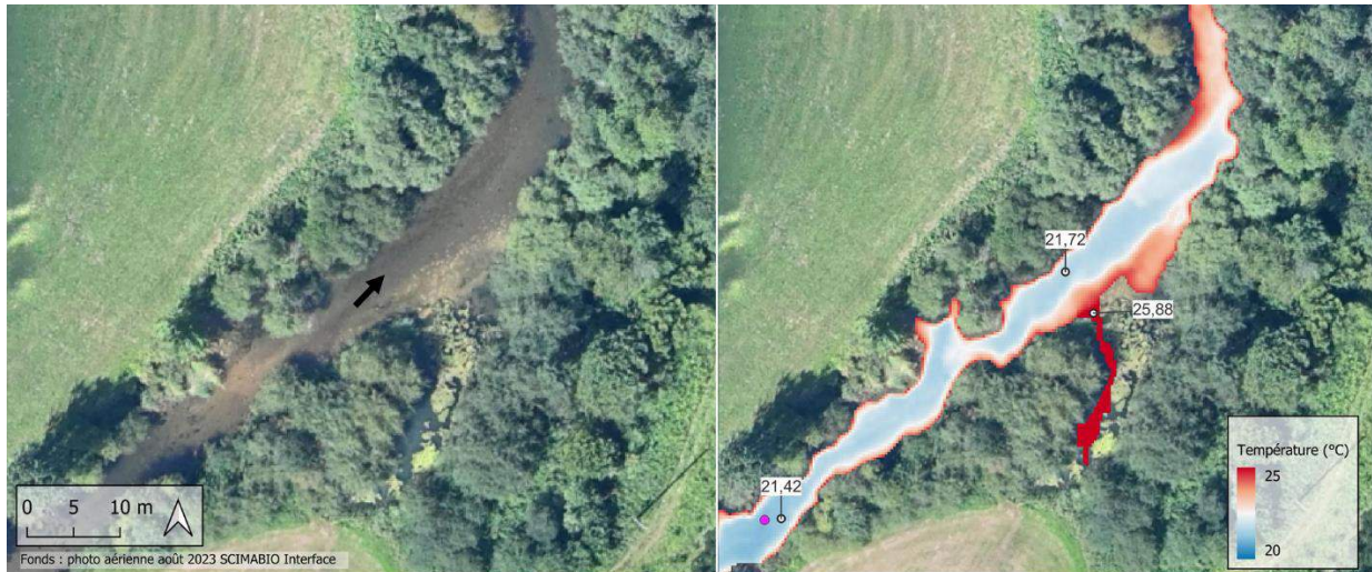
Figure 48 : Mosaïque thermique et orthophoto de l'annexe hydraulique chaude (zoom 1 de la figure 47).
