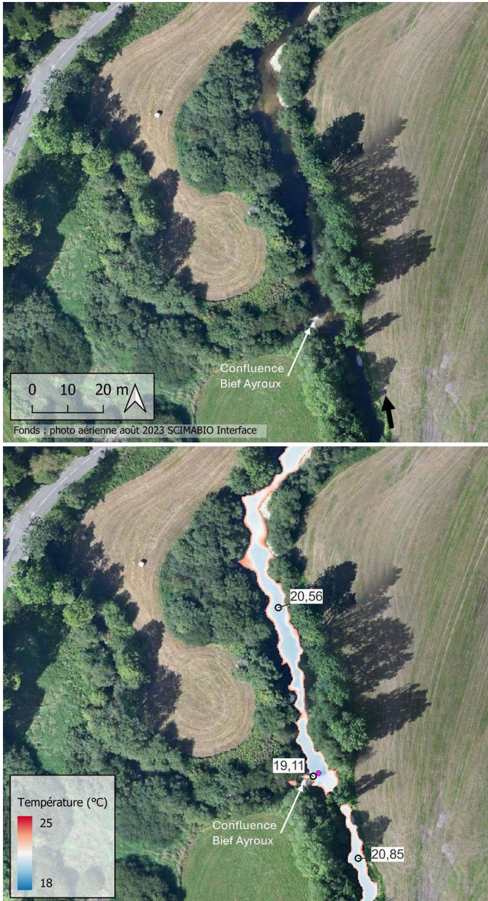
Figure 70 : Mosaique thermique et orthophoto illustrant l'apport d'eau plus froide repéré au niveau de la confluence du Bief Ayroux (zoom 2 de la figure 68).
