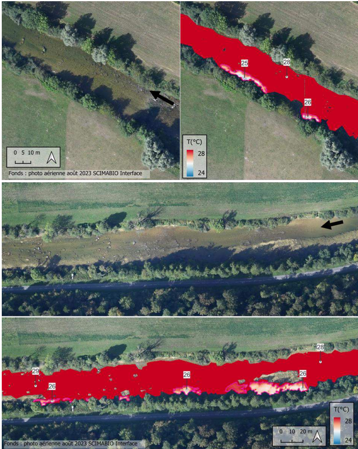
Figure 122 : Mosaïque thermique et orthophoto illustrant les deux zones de suintements latéraux rive gauche observée entre Brémencourt et Glère (haut : point kilométrique 0.8, bas : point kilométrique 2.4).
