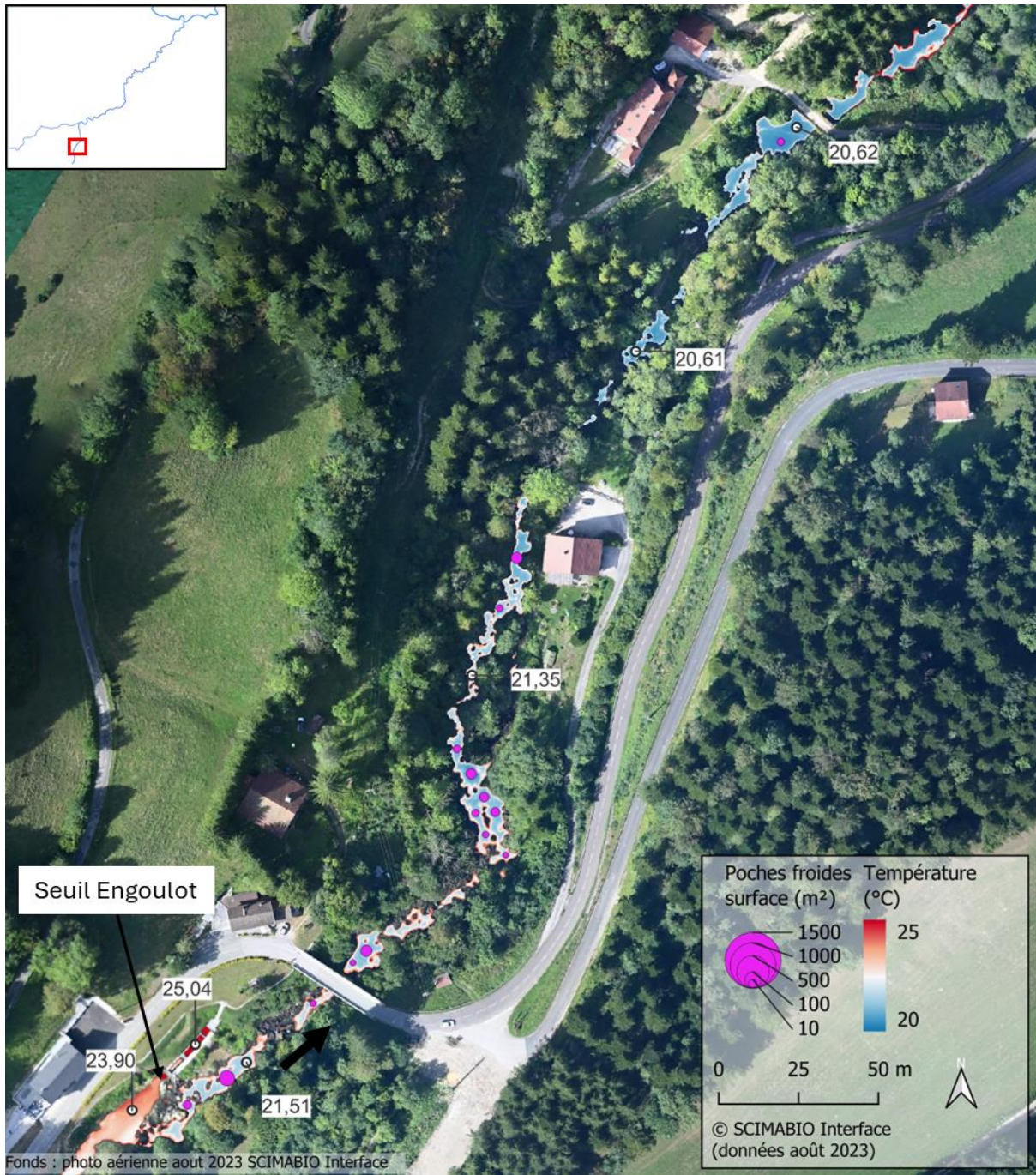
Figure 71 : Mosaïque thermique illustrant les poches froides repérées à l'aval du seuil de l'Engoulot (zone F_De2).
