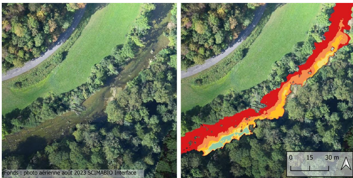
Figure 97 : Mosaïque thermique et orthophoto illustrant des petites résurgences en rive droite (entre Blanche Fontaine et Pont de Fleurey) avec une amélioration locale des conditions thermiques vis-à-vis des salmonidés (légende des couleurs voir figure 90).
