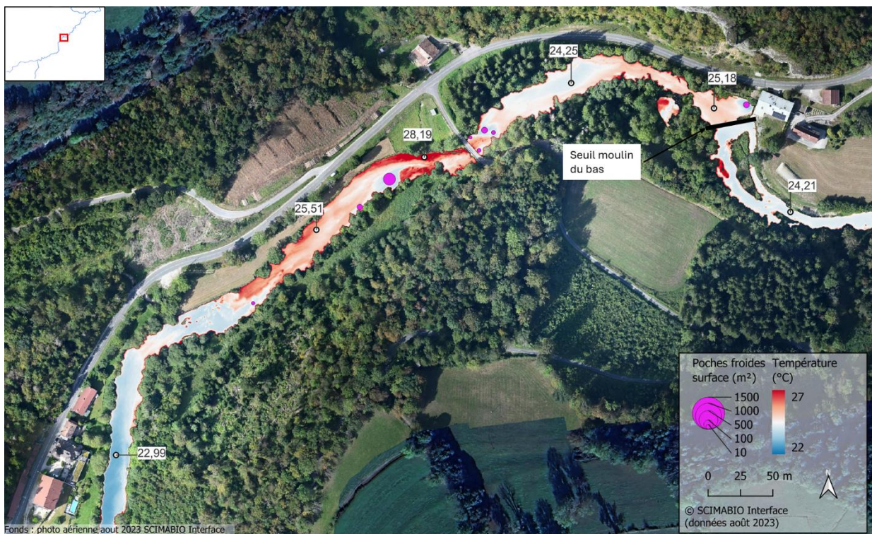
Figure 56 : Mosaïque thermique illustrant le réchauffement observé en amont du seuil du moulin du bas partiellement compensé par la présence de poches froides (zone C_De7).
