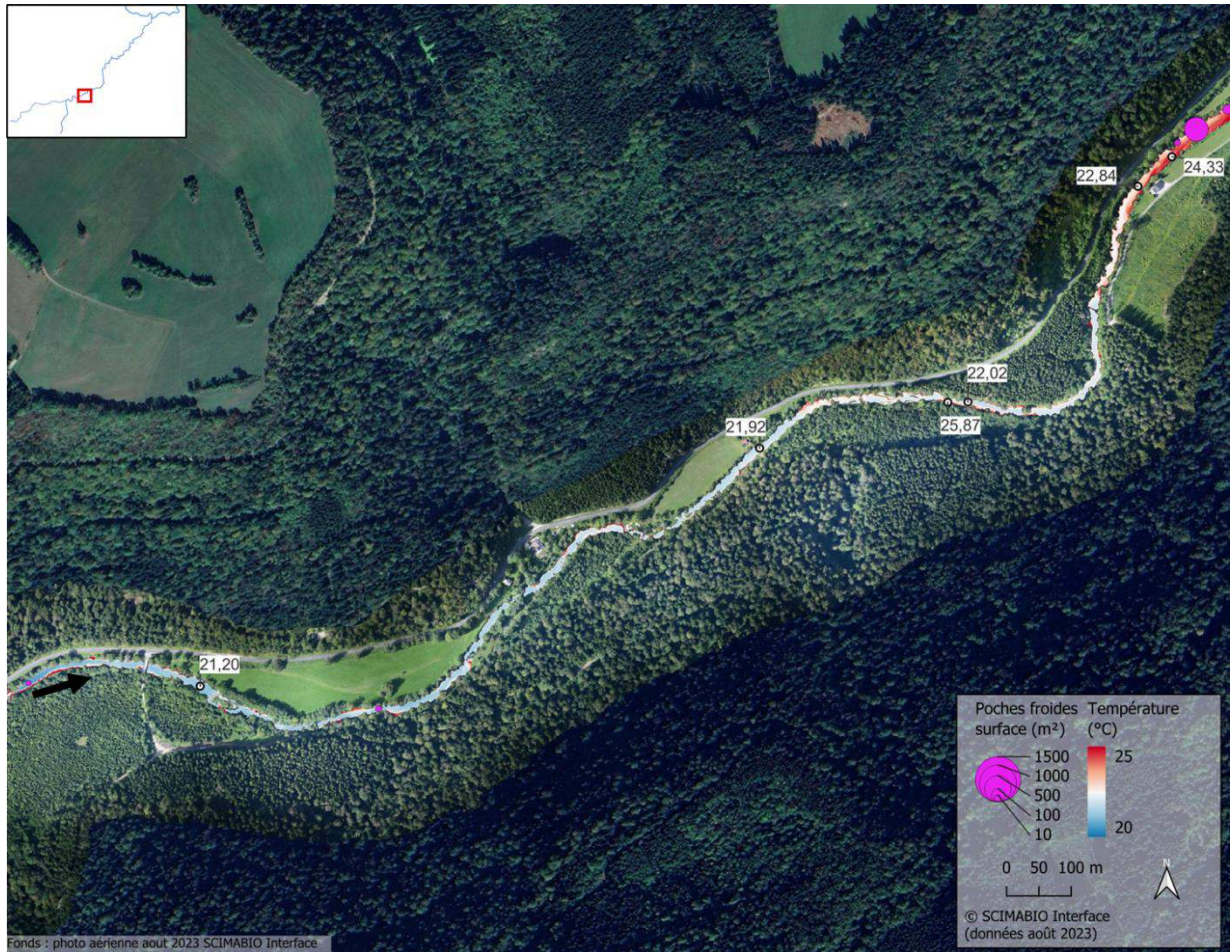
Figure 54 : Mosaïque thermique illustrant un linéaire avec une absence de poches froides entraînant un réchauffement progressif (zone C_De5).
