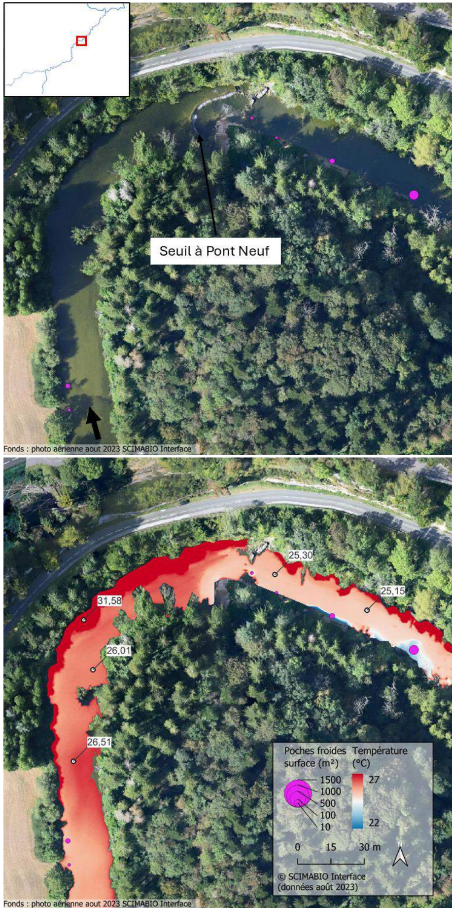
Figure 57 : Mosaïque thermique et orthophoto illustrant le réchauffement observé en amont du seuil de Pont Neuf (zone C_De8).
