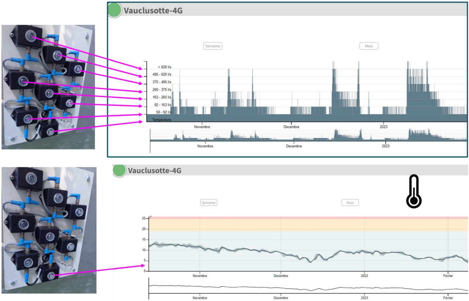
Figure 17 : Illustration du fonctionnement des sondes SQUAMA. Chaque sonde indique la mise en eau d'une cote de la Vauclusotte, correspondant à un débit de la rivière. La sonde la plus basse enregistre également la température de l'eau.
