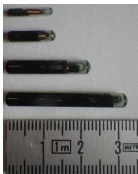
Figure 6 : Exemple de différentes tailles de transpondeurs passifs utilisées pour le marquage des poissons
