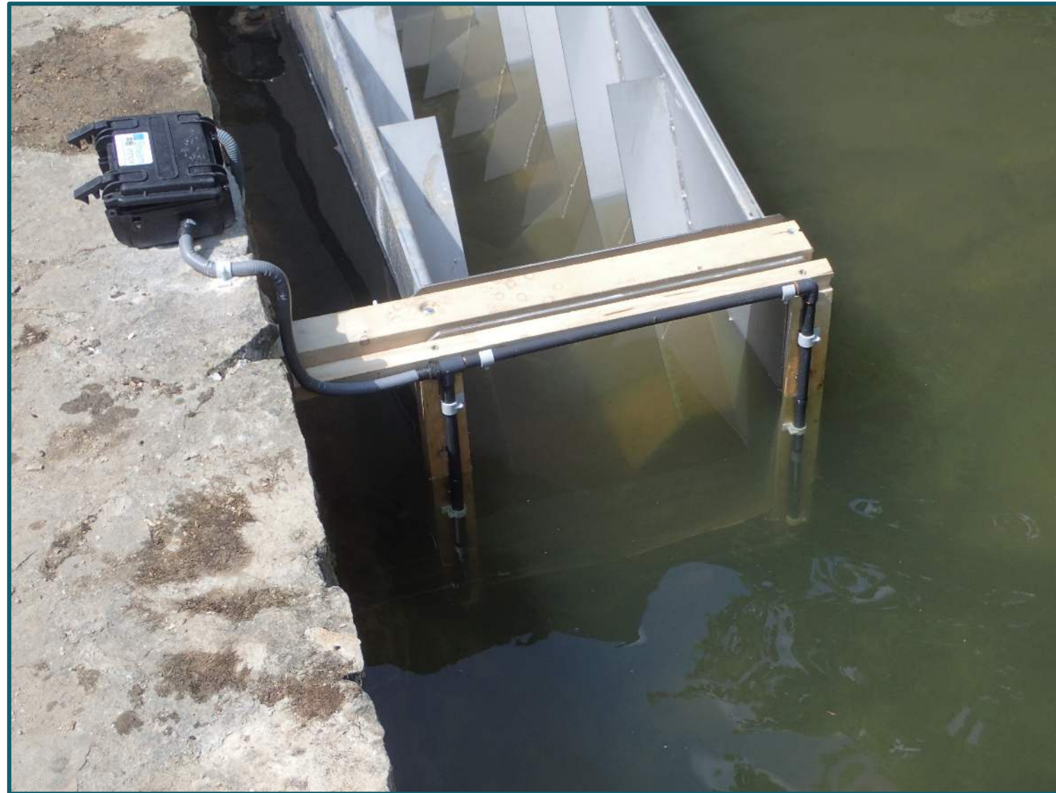
Antenne n°2 en entrée de la passe / Antenne Nr. 2 am Eingang des Passes
